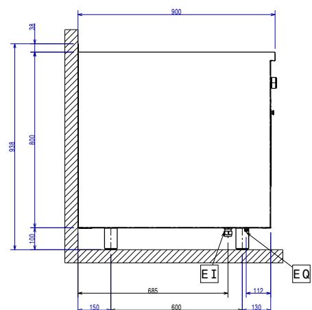
EI = Conexión eléctrica (energía)
